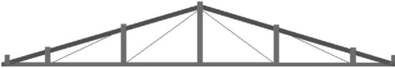
**Abb. 4:** Gut zu erkennen sind die typischen Felder eines Fachwerks. Die dünnen Bänder in den Feldern sind auf Zug belastet, die senkrechten Balken auf Druck.
